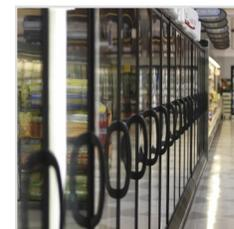
**試験方法：**Visgard LTF 300 防曇フィルムを取り付けた冷蔵庫のドアを10分ごとに6秒ずつ開け、それを1時間繰り返しました。ドアを閉じた後、結露や霜が生じた場合、消えるまでの時間が記録されました。特定条件にて一時間の間に全7回の平均を記録する作業が行なわれました。各条件は同じ方法で試験されました。
